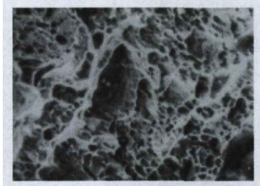
图3 螺钉断口韧窝处的白色夹杂物( \times 500 )
