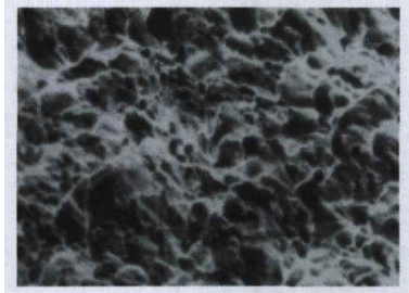
图4 螺钉头部断口形貌( \times 500 )
